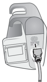
Connexion d'une sonde SpO 2
